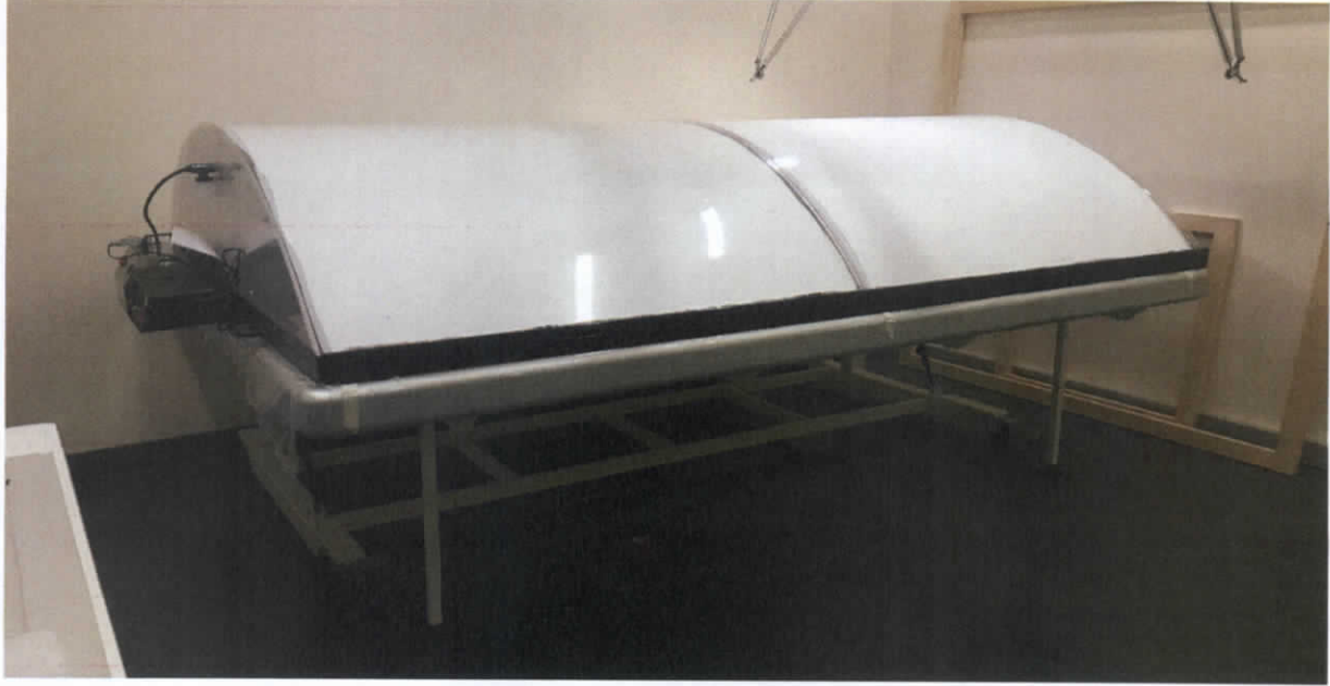
Resim Restorasyon Atölyesi ve Laboratuvarı Cihazları- Vakum masası
