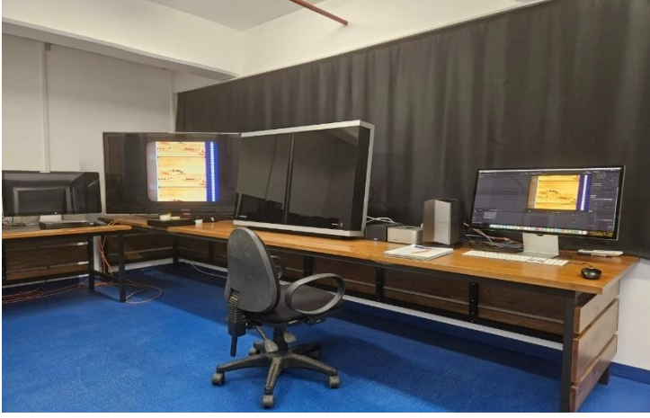
Black Magic Cintel Scanner ve Desktop Mac Bilgisayar'da 16-35 mm Filmlerin Yüksek Çözünürlükte Taranarak Dijital Ortama Aktarılma İşlemi
