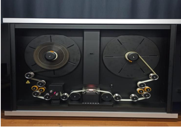
Black Magic Cintel Scanner ve Desktop Mac Bilgisayar'da 16-35 mm Filmlerin Yüksek Çözünürlükte Taranarak Dijital Ortama Aktarılma İşlemi
